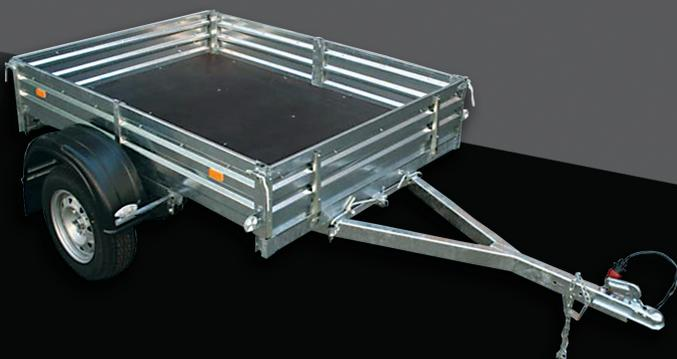
Для удобства эксплуатации кузов прицепа опрокидываемый (функция самосвала), передний и задний борта открываются.
